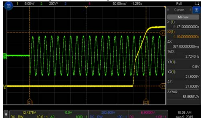
CH1 : Output Voltage CH2 : AC Input Voltage
